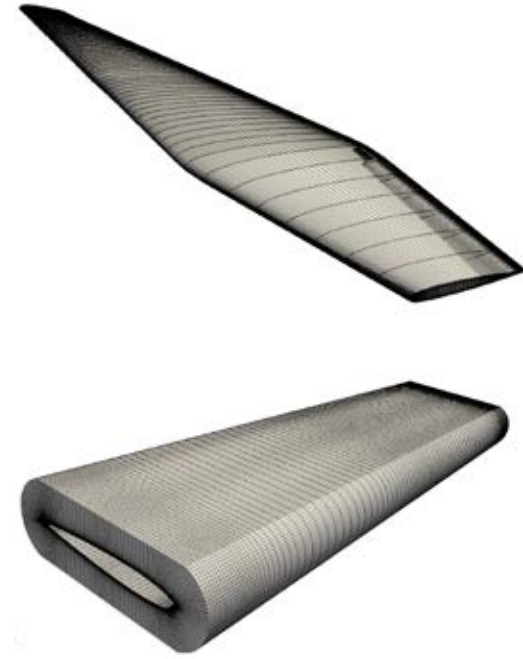
Şekil 2 Figure 2. Rotor palı yüzey ağı örneği Example of rotor blade surface mesh
