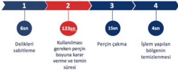
Şekil 3. İşlenmesi Zor Olan Bir Parçada Perçinleme İşlemi
