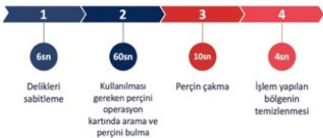
Şekil 4. İşlenmesi Kolay Olan Bir Parçada Perçinleme İşlemi
